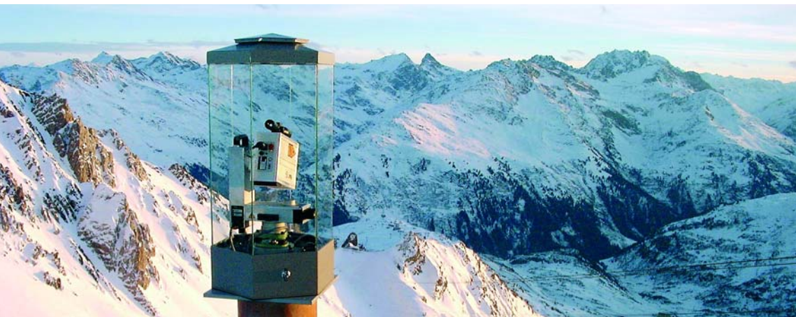
Laserscanner am Arlberg zur Lawinenüberwachung
